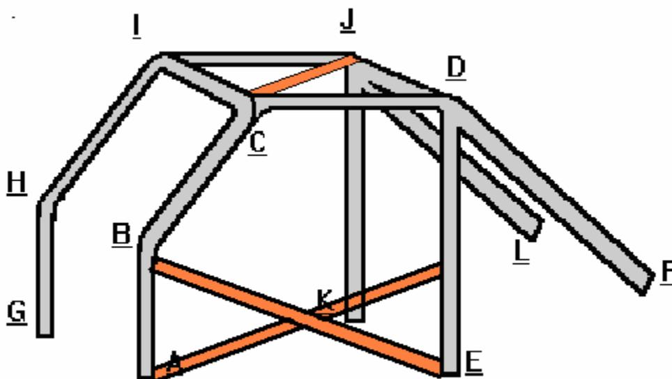
Los puntos A y G del arco delantero, y los E y K del arco principal, y los puntos F y L de los tirantes Longitudinales deberán ser soldados a una planchuela de fijación 3/16, la cuál estará fijada al piso del vehículo por medio de bulones o soldadura.
